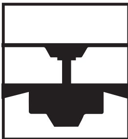
Instalación con vara
